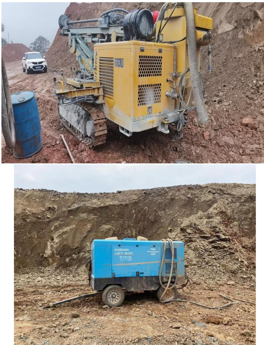
图 2-7 履带式潜孔钻、移动式空压机
